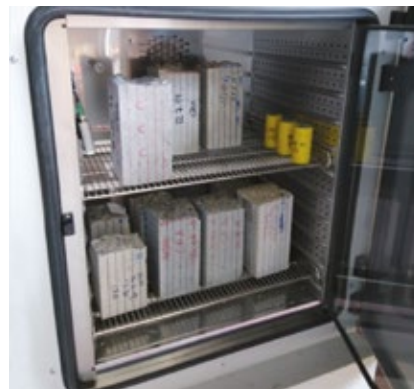
Κλιματικός θάλαμος με πρισματικά δοκίμια για επιταχυνόμενη ενανθράκωση (Ελβετικό Πρότυπο SIA 262/1-X)
